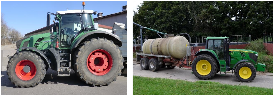
Abbildung 13: Landmaschinen mit Umrüstung auf Pflanzenölkraftstoff, links Zwei-Tank-System, rechts Ein-Tank-System
