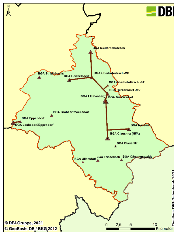
Abbildung 48: grafische Darstellung der modellierten Netze im Szenario 2 (MP-Milchproduktion, SZ-Schweinezucht, MV-Milchvieh, NFA-Nassfermentationsanlage)
