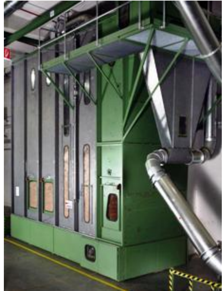
Mixmaster zur Homogenisierung der Fasermischung
